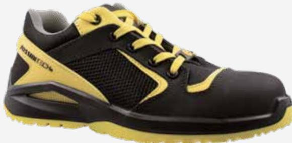
**OLIMPIA** plitke cipele S1P nivoa zaštite, sa kelvarskim međudonom i fiberglas zaštitnom kapom, koja se sastoji od staklenih niti međusobno povezanih sintetičkom smolom, što je čini izrazito laganom, tankom i elastičnom. Izrađene su od nubuk kože u kombinaciji sa mrežastom tkaninom u crnoj boji, sa žutim detaljima. FLEKSI umetak u tkanini olakšava fleksibilnost u predelu prednjeg stopala.
