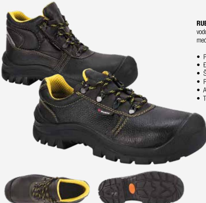
**RUBBER GUARD** plitke i duboke radne cipele S3 nivoa zaštite su vodoodbojne, napravljene od kože, sa kompozitnom kapom i kelvarskim međuđonom.
