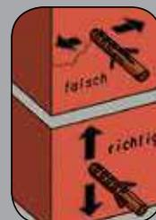
Obratite pažnju na propisano rastojanje od ivice
